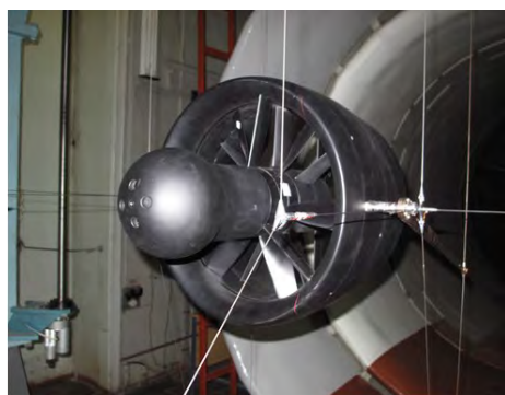
Рис.2 – Монокоптер ЦАГИ в АДТ
