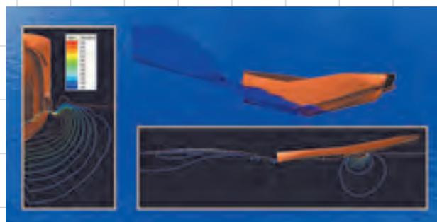
Рис. 13. Волнообразование, граница раздела сред, положение корпуса и распределение давления в области редана модели на скорости глиссирования 6,0 м/с, соответствующей «горбу сопротивления»
