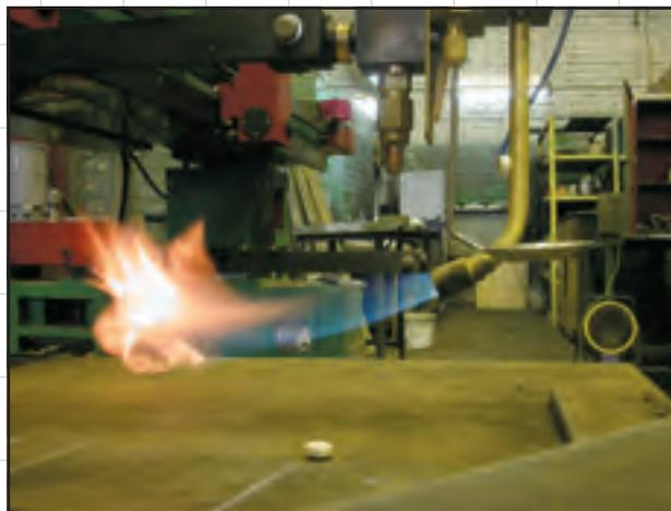
Рис. 1. Февка, используемая компанией «Автогенмаш», в процессе горения при давлении смеси пропан-бутан (0,17 МПа)
