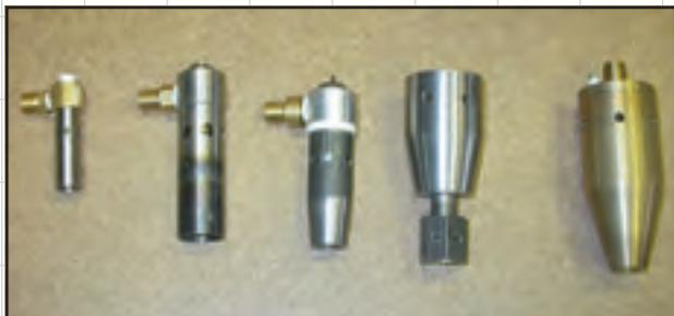
Рис. 7. Конструкции узла поджига, спроектированные с помощью программы FlowVision и прошедшие лабораторные испытания
