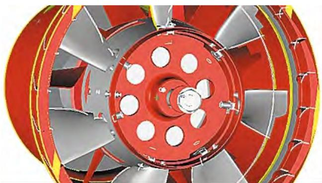
*Рис. 2. Элементы сборочной модели изделия. Видны стандартные крепежные элементы и представление элементов проточной части (лопаток) в виде отдельных деталей*
