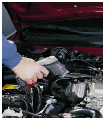
В автомастерской. Проверка шланга радиатора и термостата.
