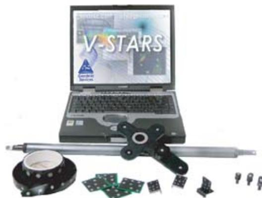
Система V-STARS включает в себя: одну или несколько камер INCA3 (или NIKON D2X), проектор PROSPOT, направляющий на объект мощный поток света либо проецирующий через специальные слайды до 23000 светящихся точек, программное обеспечение для обработки результатов замеров, а также большое количество различных маркеров, отражателей, щупов и аксессуаров, помогающих решить практически любую задачу измерения.
