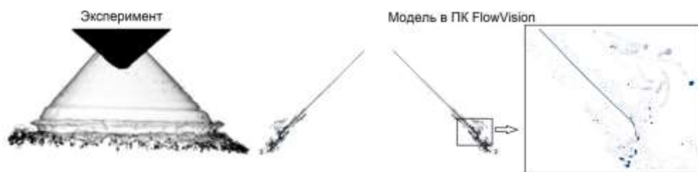
Рис.2. Моделирование распада струи, формируемой форсункой клапанного типа
